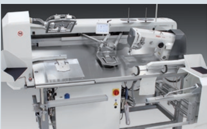
PFAFF 3588 - Programmierbarer Taschenautomat für das Verarbeiten von nicht-vorgebügten Taschen
