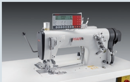
PFAFF 5489-H - Doppelkettenstich-Spezialschnellnähler mit Differential-Untertransport für Kappnähte
