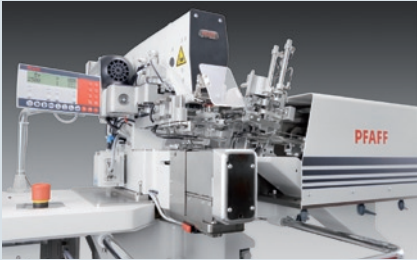
PFAFF 3840 - Nähautomat zum Annähen von Gürtelschlaufen
