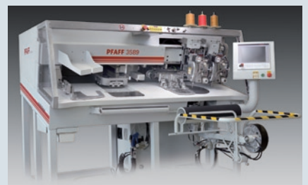
PFAFF 3589 - Programmierbarer Taschenautomat mit zwei Nähköpfen für das Verarbeiten von nicht-vorgebügten Taschen
