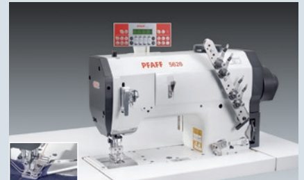
PFAFF 5626 - Doppelkettenstich-Spezialschnellnäher zum manuellen Annähen des Hosenbundes
