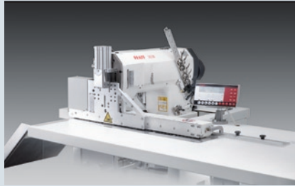
PFAFF 3538-20/02 (Basic) - Taschenaumautomat ohne Kettentrenner
