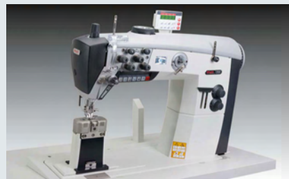
PFAFF 2595/2596 – Ein- und Zweinadel-Doppelstepstich-Säulenmaschine mit Unter-, alternierendem Ober- und Nadeltransport
