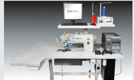
KSL 210 Naht-Dokumentations-System – Gestalteter Näharbeitsplatz zum Einsatz in der Autositzfertigung und anderen Bereichen sicherheitsrelevanter Schließnähte
