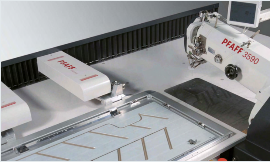
CNC-gesteuerte Nähanlage für dekorative Ziernähte CNC-controlled sewing unit for decorative seams
