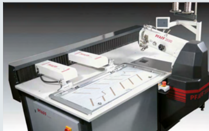
PFAFF 3590 Vario – Frei-programmierbarer Großfeld-Nähautomat für Zier- und Montagenähte
