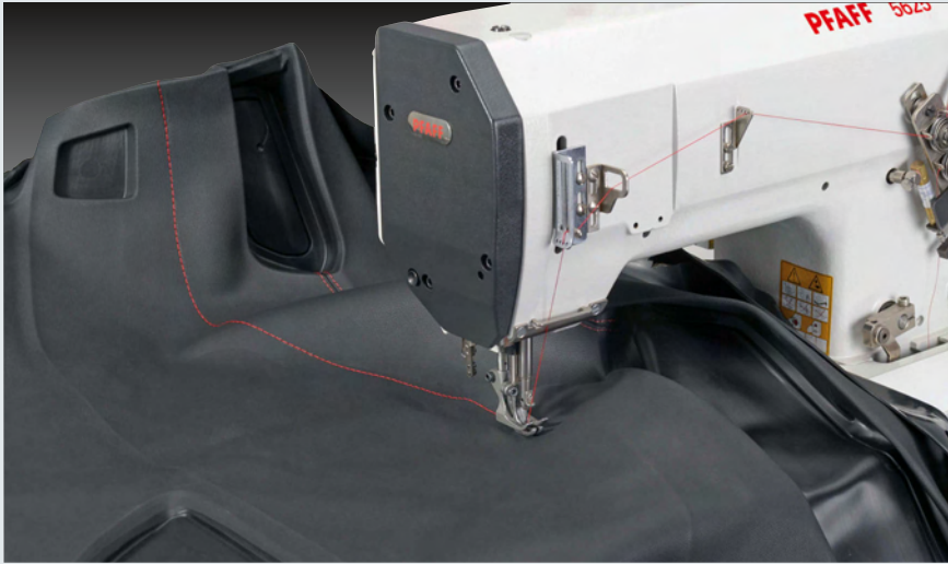
Flachbett-Maschinen für universelle Zier- und Montagenähte Flat bed machines for universal decorative and assembly seams
