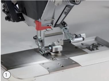
Echtzeitüberwachung der Fadenspannung (Stich für Stich) ①
