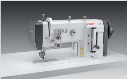
PFAFF 1243 - Einnadel-Flachbettmaschine mit Radtransport für den Einsatz im schweren Anwendungsbereich
