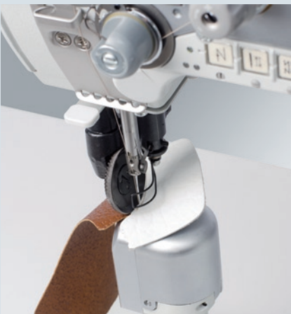
Montagenähte beim Kinderschuh Assembly seams on a children shoe
