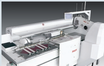
PFAFF 3587 - Frei-programmierbarer Großfeld-Nähautomat mit Wechselklammer für voll-überlappte Arbeitsweise (500 x 300 mm)
