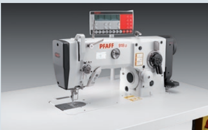
PFAFF 918-49/01 - Zickzack-Schnellnäher mit Untertransport und großem Greifer um Kante an Kante zu nähen
