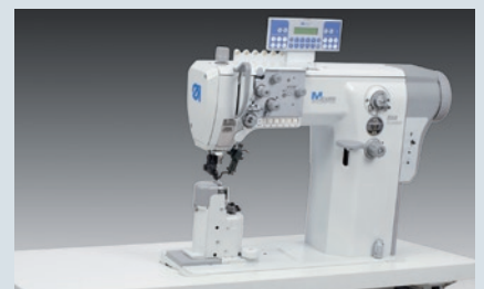
Dürkopp Adler 888-356...-M - Einnadel-Säulenmaschine (Säule links) mit integriertem Direktantrieb und Unterschneideinrichtung
