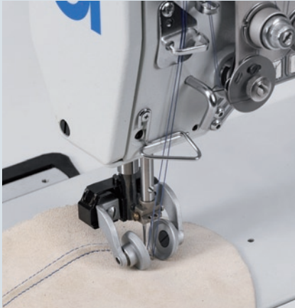
Wulstnaht im Blattbereich Cording seam on vamp
