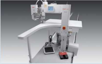
PFAFF 8390 - Programmierbare, fahrbare Heizkeil-Schweißmaschine mit erweiterbarer Gleisanlage
