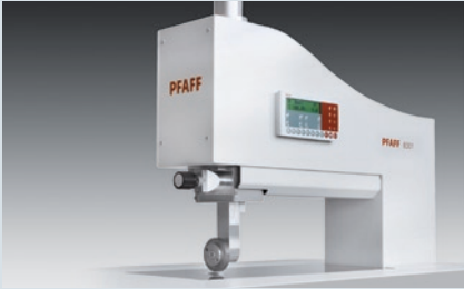
PFAFF 8301 - Flachbett-Ultraschallschweißmaschine: Die ökonomische Lösung
