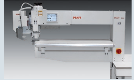
PFAFF 8320-010 - Programmierbare Heißluft-Schweißmaschine für das Verschweißen von PVC-Materialien
