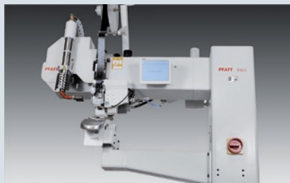
PFAFF 8323 (Spezial) - Programmierbare Heißluft-Bandschweißmaschine mit speziellen Silikonwalzen für das Abdichten von Cabriodächern
