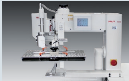
PFAFF 8320-020/061 - Programmierbare Heißluft-Schweißmaschine mit verstellbarer Schlauchführung
