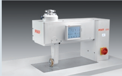
PFAFF 8310 - Programmierbare Flachbett-Ultraschallschweißmaschine (Optional mit Puller)
