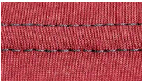
KEINE MATERIALBESCHÄDIGUNG MEHR SICHTBAR – RICHTIGE NADELICKE WURDE GEFUNDEN.
