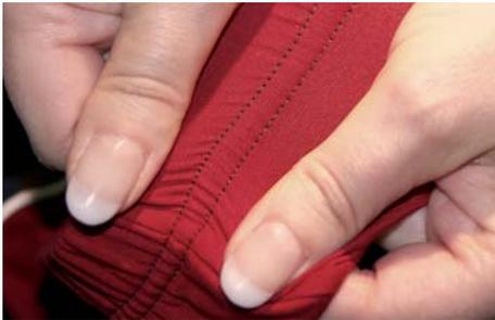
NAHTPRÜFUNG: DURCH LEICHTE ZUG- UND SCHERBEWEGUNGEN WERDEN MATERIALBESCHÄDIGUNGEN (BILD 2) SICHTBAR.
