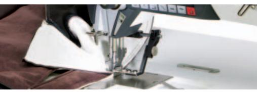
Schließnähte/Verbindungsnähte bei Vormontagearbeiten in der Automobilindustrie
